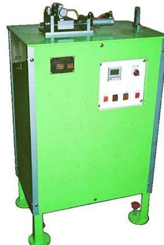
JIA-630 光纖連接器往復插拔試驗機
