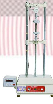
**JIA-601A 電動桌上型拉力試驗機**
