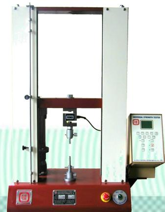
**JIA-803TOW 精密型微電腦拉力試驗機**
