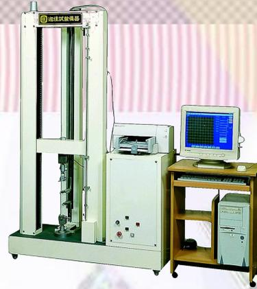
**JIA-801PC 電腦拉、壓力試驗機**
