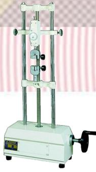
**JIA-601B 電動桌上型拉力試驗機**
