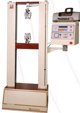
**JIA-801E 桌上型微電腦拉、壓力試驗機**
